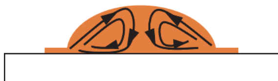
图3 “草帽形”液滴的内部液体流动的示意图
