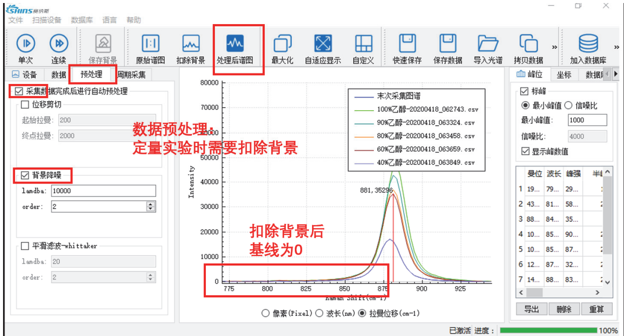
图6 便携式拉曼光谱仪测试乙醇图
