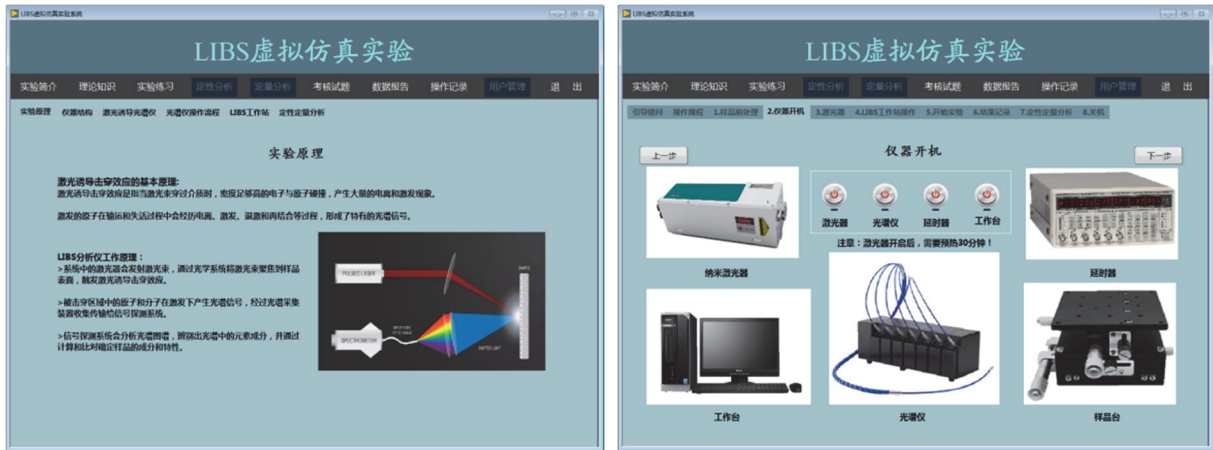
图3 LIBS分析虚拟仿真实验实验原理(左图)和仪器核心部件(右图)
