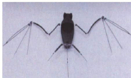
图9 蝙蝠机器人关节和肌肉 [7]
