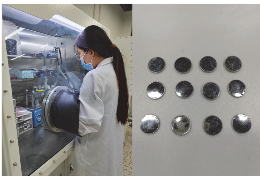
图1 学生独立操作手套箱和组装的锂离子纽扣电池。
