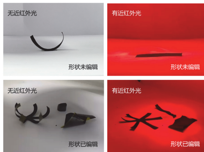
图6 近红外光照下PI/PDMS/Graphene薄膜的光响应致动
