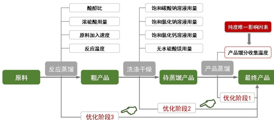
图1 乙酸乙酯合成实验的“逆向-逐级”优化过程
