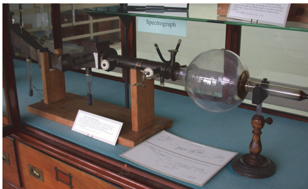
图3 阿斯顿发明的质谱，目前放置在剑桥大学卡文迪许实验室博物馆 [4]
