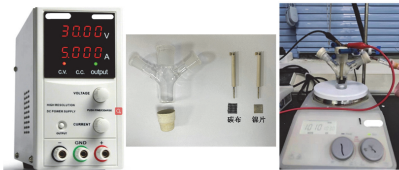
图3 N -酰基磺酰胺的 electrochemical 去芳香螺环化反应的实验装置
