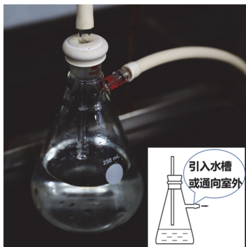
图2 由导气管、抽滤瓶组成的气体吸收装置
