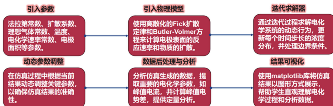
图3 CV数字化仿真程序的设计流程图
