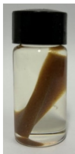
图3 B-KH580交联SBR在甲苯中溶胀72 h后的照片
