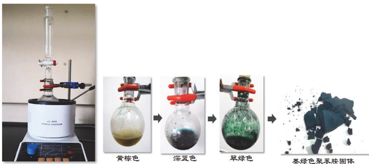
图3 聚苯胺制备装置图及反应现象
