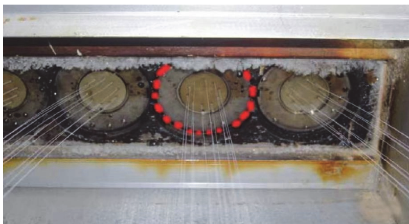
图6 喷丝板上聚集的环状二聚体
