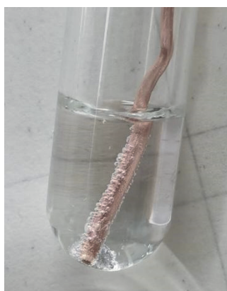
图3 锌的析氢电化学腐蚀实验现象
