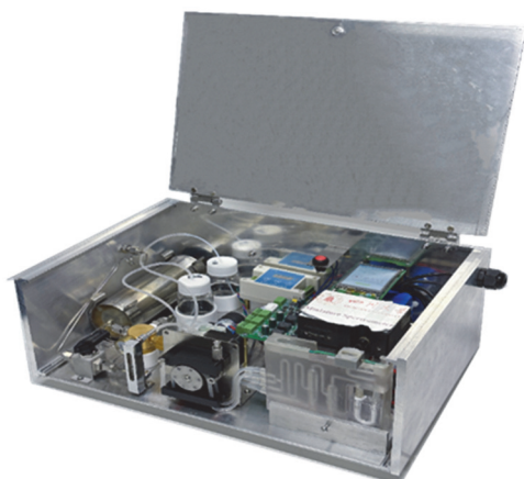
图8 自搭建教学微等离子体原子发射光谱仪实物图
