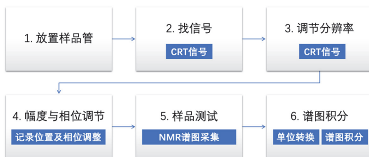
图3 核磁仪和自编软件的配套使用流程
