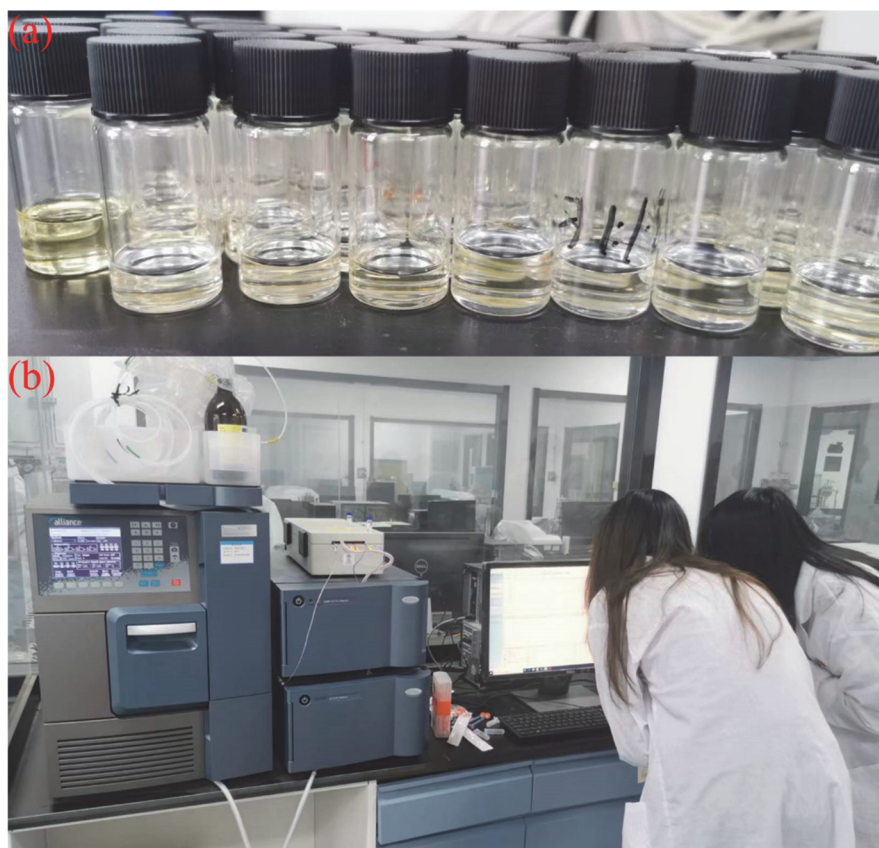
图7 (a) 硫-烯点击聚合反应样品实物图和(b) GPC仪器上机操作
