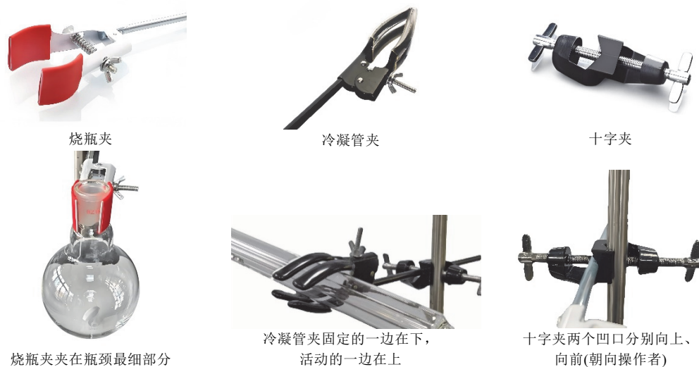
图3 蒸馏夹具的安装示意图
