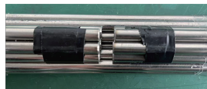
图 15 模拟截面积损失的钢丝束
