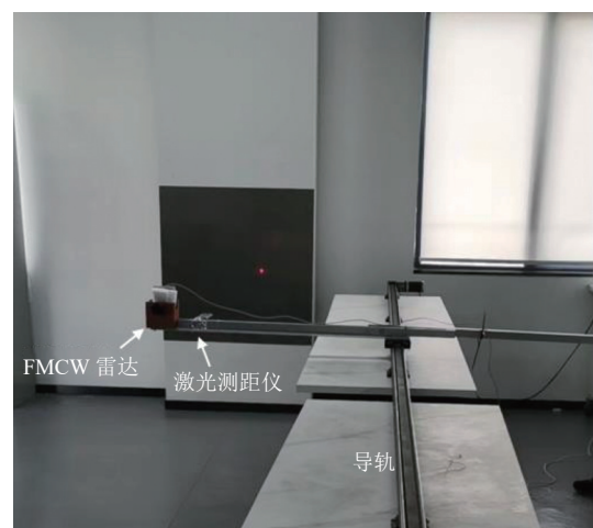
图 7 FMCW 雷达测距场景
