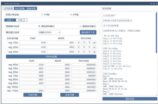
图 8 DAC&系统寄存器配置及回读
