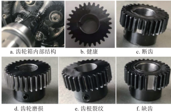
图 2 齿轮箱及齿轮状态示意图 [25]
