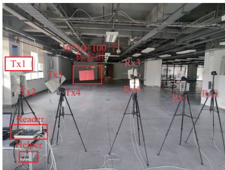
图 7 基于收发分离 RFID 无源物联网系统示意图
