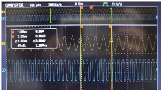
图 6 电路级测试时示波器显示的巨磁阻隔离器输出曲线
