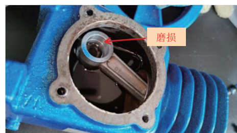
图4 往复式压缩机曲轴磨损故障
