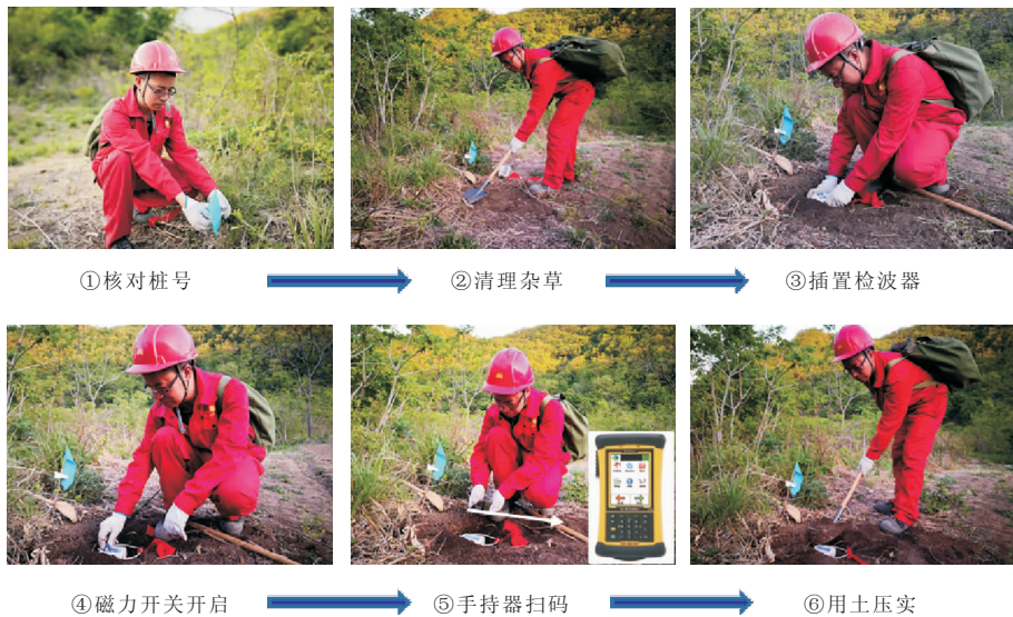
图 4 节点仪器埋置标准
