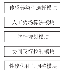
图 2 多无人机协同测绘航迹规划模型结构
