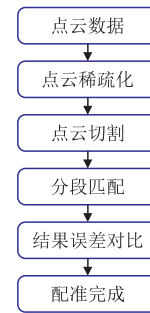
图 1 狭长复杂空间点云数据配准流程
