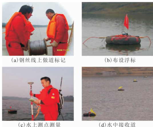
图 1 钢丝绳辅助定位方法野外操作图
