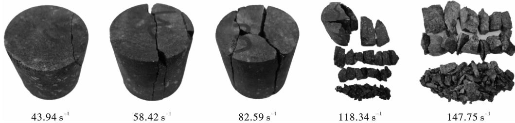
图9 不同加载应变率下磁铁矿石破坏形态
