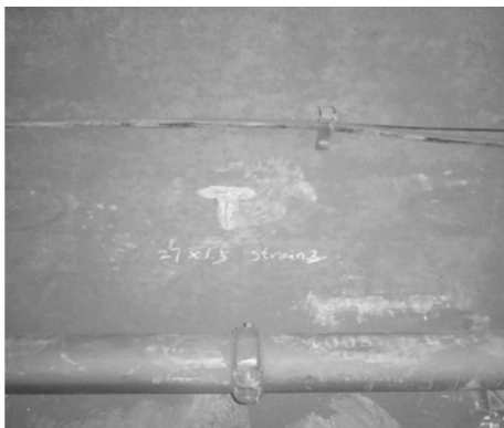
图5 应变片现场布置图
