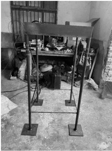
图2 实验所使用的固支方板
