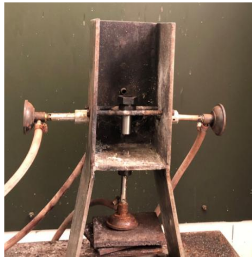
图4 克南试验装置
