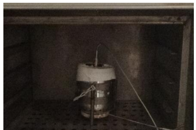
图 2 热安定性试验装置
