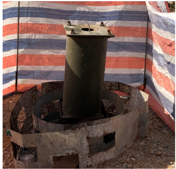
图5 改进通风管试验装置
