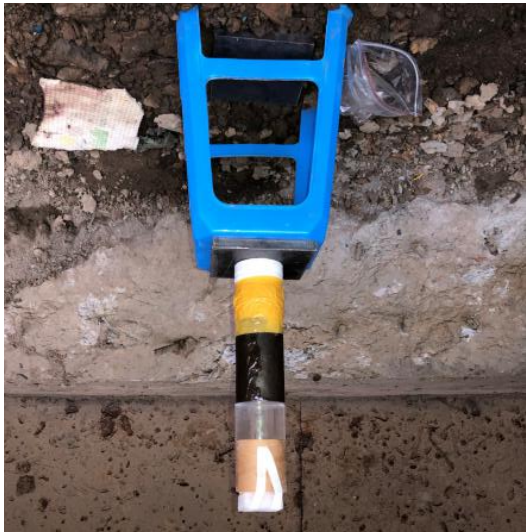
图3 隔板试验装置
