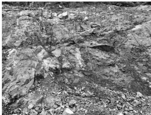
图 3 矿山经验爆破参数爆后效果
