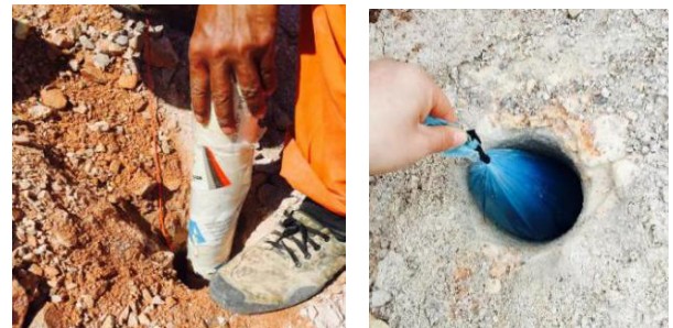
图 2 中部空气间隔、水不耦合装药
