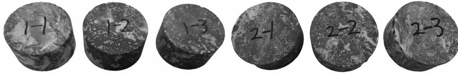
图 1 SHPB 冲击试验部分岩样图
