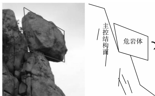
图1 倾倒式危岩体示意图
