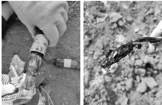
图8 爆燃后的液氧药包示意图
