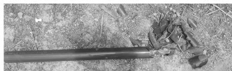
图 2 殉爆实验后的 PVC 管
