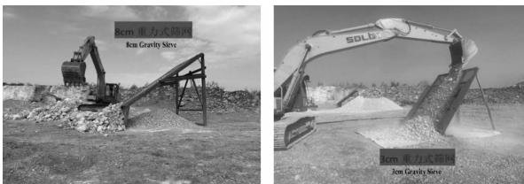
(a) 8 cm 重力式筛网 (a) 8 cm gravity sieve (b) 3 cm 重力式筛网 (b) 3 cm gravity sieve
