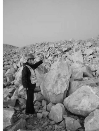
图 2 现场爆堆大块图 Fig. 2 Boulder after blast
