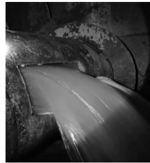
图9 聚能切割后的钢管切口
