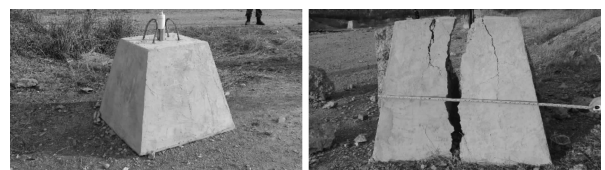
图 16 直径 80 mm 小锥角的聚能装药设置及效果
