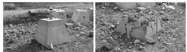
图 15 直径 112 mm 曲率半径 115.4 mm 的 EFP 装药设置及效果
