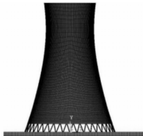
图 9 冷却塔有限元模型
