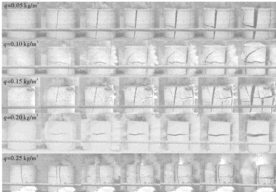
图5 不同单耗时单基发射药爆破试块
