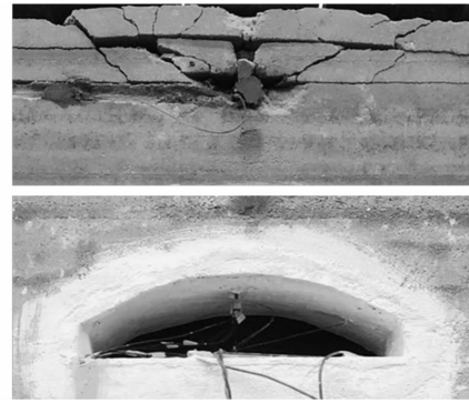
图 5 试验模型破坏形态
