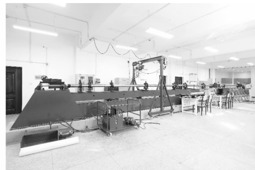
图 2 分离式霍普金森压杆试验系统
