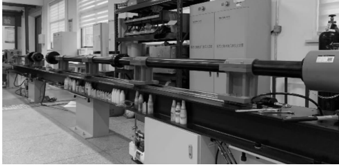
图3 二级轻气炮实验装置
