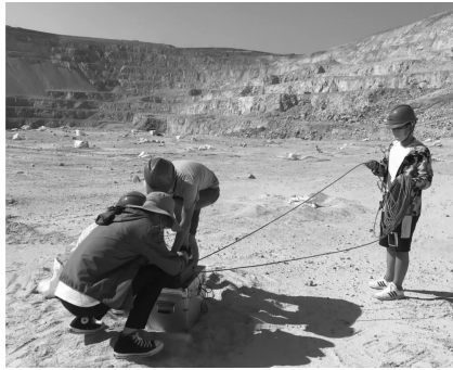
图 3 钻孔摄像测试现场
